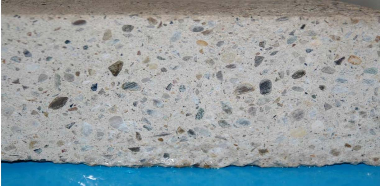
**KBS Fließmörtel** hat bei fachgerechtem Einbau eine **feste Oberfläche**. Das Zuschlagskorn ist gleichmässig über den gesamten Querschnitt verteilt. Eine „Sinterschicht“ ist nicht vorhanden.
